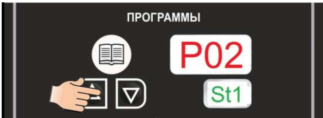
При нажатии и отпускании кнопки  $\Delta$  значение номера программы изменяется на +1.
