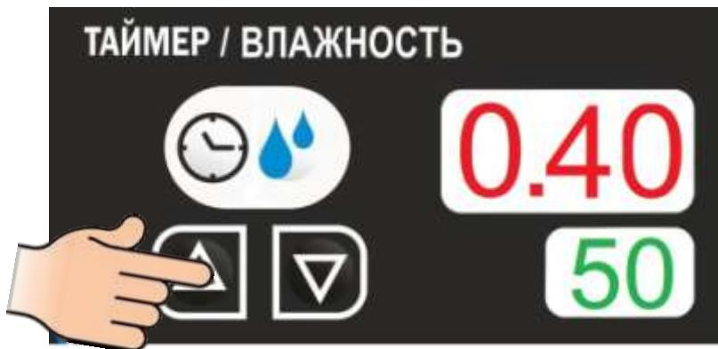
Повторное нажатие кнопки «» вызывает сохранения параметра в память контроллера. При этом индикатор заданного значения изменяемого параметра перестает мигать.
