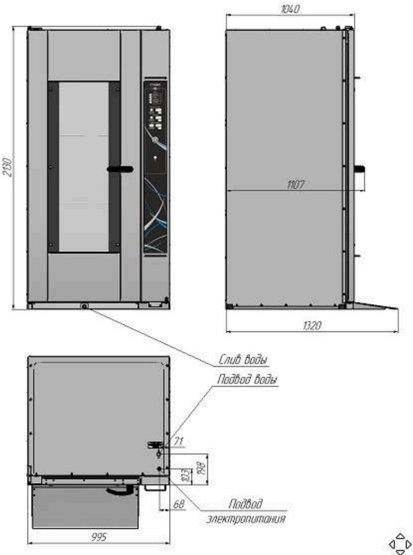
Рис.2 Шкаф расстояочный тепловой ШРТ-18П.
