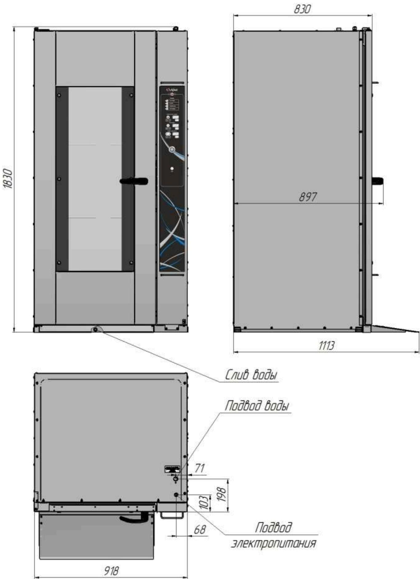
Рис.1 Шкаф расстояечный тепловой ШРТ-16П.
